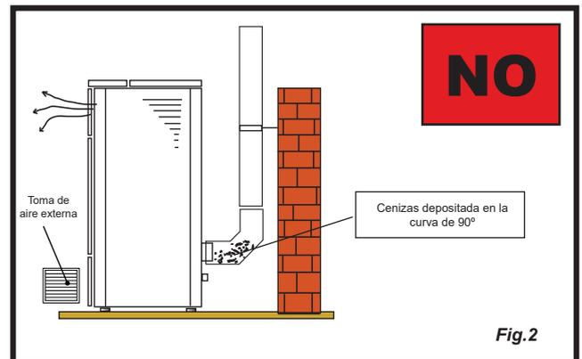
Es posible aprovechar un tubo de humos o un canal mediante un conducto. Para este tipo de instalación es necesario respetar las normas relativas a los sistemas de evacuación de humo en conductos. En la parte inferior del tubo de humos ubicado dentro de la casa se ha instalado un conector tipo "T" con tapa de inspección; en el exterior se ha instalado otro, para que el tramo externo se pueda inspeccionar.
