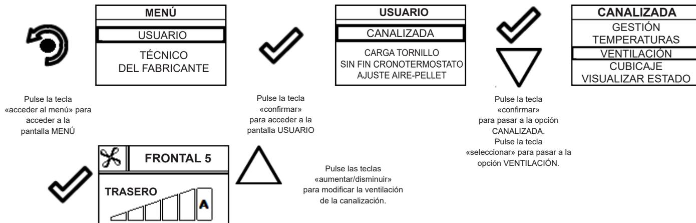
La parte superior de la pantalla muestra las velocidades de la ventilación frontal, que está relacionada con la potencia de la estufa (por ejemplo: Frontal 5), la parte inferior de la pantalla muestra la potencia de la canalización, que se puede modificar con las teclas «aumentar/disminuir». El valor que se puede configurar va de 0 (canalización apagada) a 5. Con la configuración en A (auto) la potencia del ventilador de la canalización se ajusta a la potencia de la estufa.
